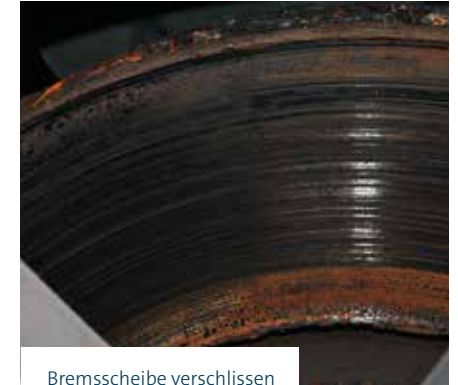
Brems Scheibe verschlissen
