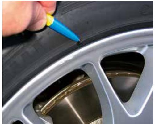
Leichte Materialabtragung an der Scheuerleiste
