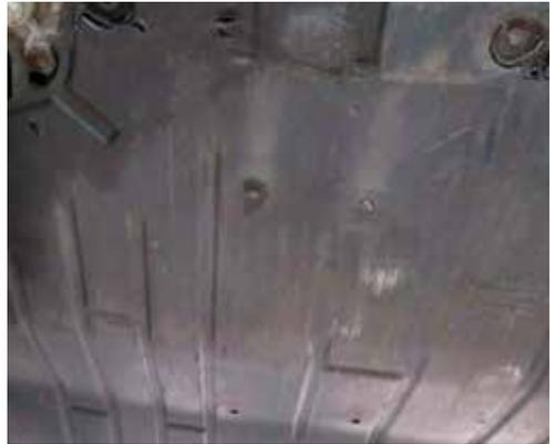
Leichte Kratzer an der Unterbodenverkleidung
