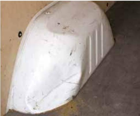
Deformation > 100 cm<sup>2</sup> am Radkasten
