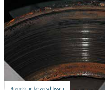
Brems Scheibe verschlissen
