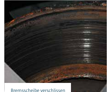
Brems Scheibe verschlissen
