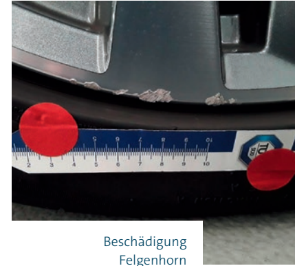
Beschädigung Felge mit Materialabtragung
