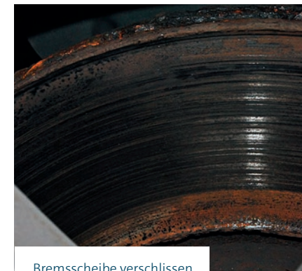
Brems Scheibe verschlissen
